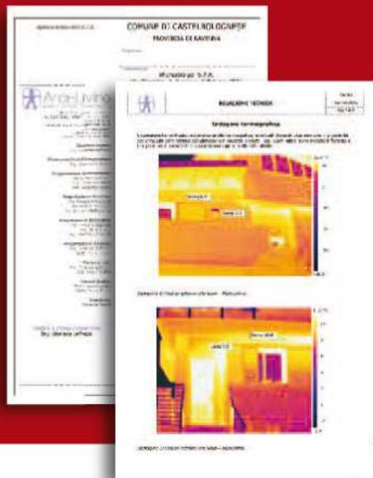
Importanza cruciale per garantire un successo prestazionale è stata l'omogeneità tra la parete rettificata e il telaio in C.A. Per scongiurare ponti termici, è stato adottato il dettaglio costruttivo in cui dei pannelli isolanti abbracciano la struttura in cemento per migliorarne le prestazioni energetiche. Le immagini della termocamera, che non evidenziano alcuna difformità termica tra la parete in Porotherm BIO PLAN e la struttura in C.A., evidenziano il successo energetico di questo involucro
