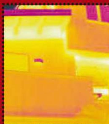
La trasmittanza è stata misurata pari a  $0,276 \text{ W/m}^2\text{K}$ , utilizzando un semplice intonaco premiscelato a base calce. La perfetta omogeneità della parete, in cui non si evidenzia alcun giunto in corrispondenza del letto di malta (che nel caso delle soluzioni rettificata è appena 1 mm)
